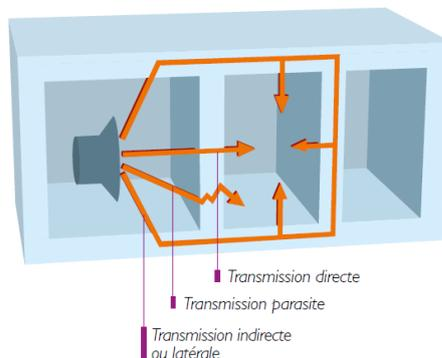
Figure 2 Le bruit peut s'insinuer par de multiples voies, et en particulier par tous les défauts d'étanchéités
